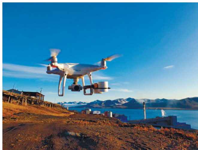
Рис. 1. БПЛА «Цимлянин» на Ладожском озере; комплекс для измерения динамики атмосферного пограничного слоя на основе квадрокоптера на Шпицбергене.
