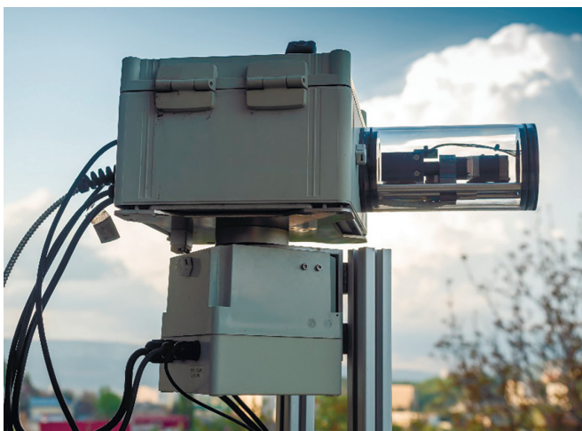
Городская измерительная площадка: автономный метеорологический комплекс для мониторинга параметров пограничного слоя и система для измерения вертикального распределения и общего содержания газовых примесей и аэрозоля в атмосфере.
