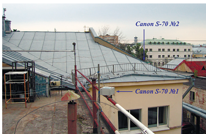
Рис. 3. Макет стереоустановки для определения высоты нижней границы облачности на крыше ИФА РАН.
